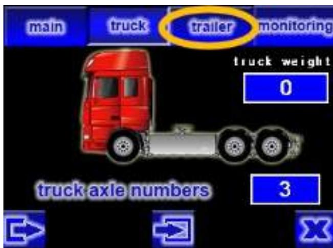
Die Anzeigeeinheit wechselt in den Anzeigemodus der Sattelaufliieger-Einstellungen, wie in der Abbildung unten gezeigt.
