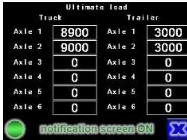
Die Einstellung der Grenzlast auf Achse Nr. 1 ist damit abgeschlossen. Wiederholen Sie den Vorgang zur Eingabe der Werte für vorhandene Zug- und Sattelachsen. Die Lastgrenzwerte für die fehlenden Achsen sind gleich "0".
