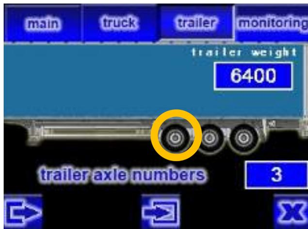
Die Anzeigeeinheit wechselt in den Modus der Anzeige der Eingabe der Einstellungen der Achse Nr. 3 (die erste Achse des Aufliegers), die im folgenden Bild angegeben ist.
