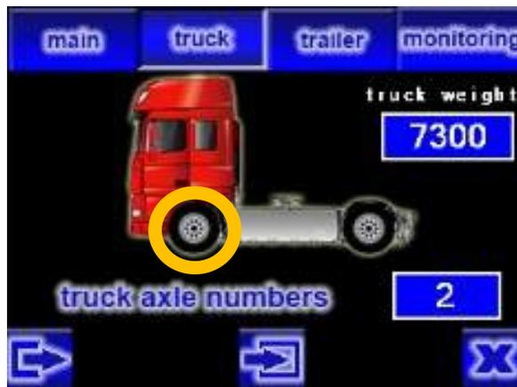
Die Anzeigeeinheit wechselt in den Modus zum Anzeigen der Eingabe der Einstellungen der Achse 1 des Traktors, wie in der folgenden Abbildung gezeigt.
