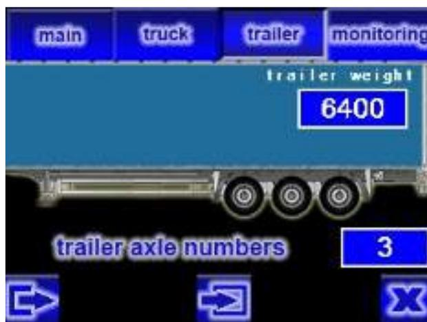
Nehmen Sie die gleiche Einstellung für Achse #4 (zweite Achse des Aufliegers) und Achse #5 (dritte Achse des Aufliegers) vor, indem Sie die Werte gemäß der Achslasttabelle und der Nummerierungstabelle des Achsdrucksensors eingeben. Die Last auf der Achse № 4 beträgt 1700 kg. und auf der Achse № 5 1650 kg.
