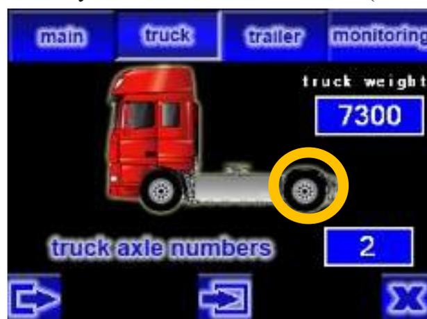
Die Anzeigeeinheit wechselt in den Modus zum Anzeigen der Eingabe der Einstellungen der Achsnummer 2 des Traktors, wie in der folgenden Abbildung dargestellt.
