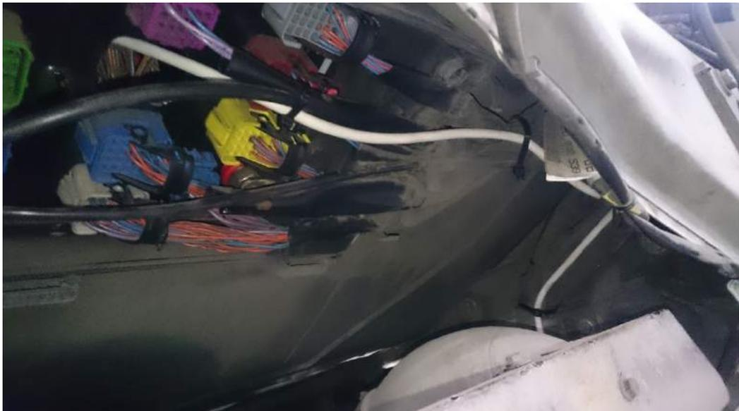
Interblock-Kabel entlang des Kabelspeißes des LKWs (Kabeleinführung in das Fahrerhaus)
