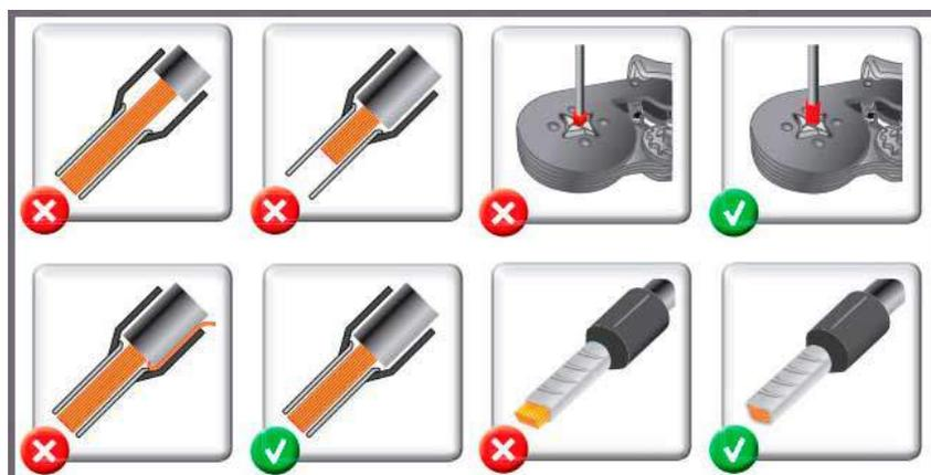
Bild #3 Montagemassnahmen für Kabelschuhe
