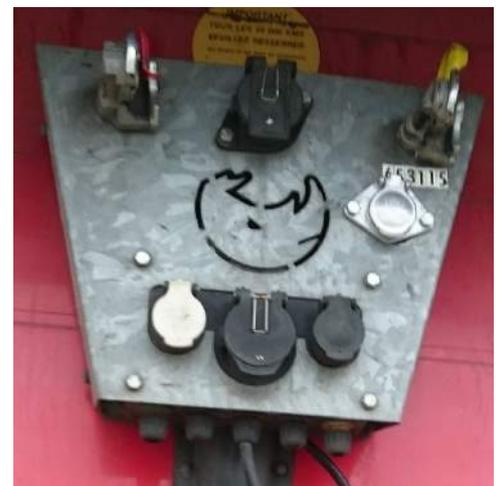
Wenn auf der Konsolenplatte kein Platz für die Steckdose vorhanden ist, müssen Sie den gewünschten Einbauort der Steckdose wählen. Markieren Sie die Position der Steckdose entsprechend der Größe der Steckdose oder kaufen Sie eine
